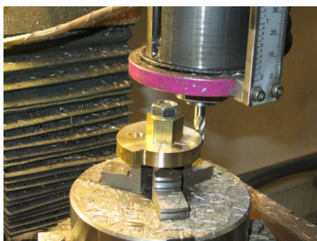
Výroba excentrické kulisy
