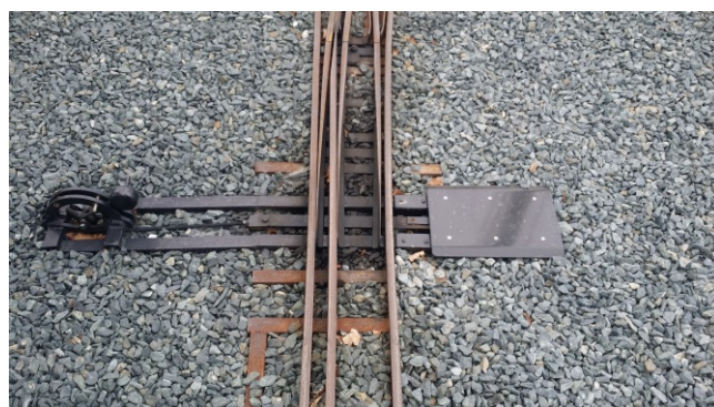
Vlevo mechanický, vpravo elektromot. přestavník
