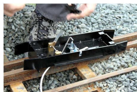
Vnitřek počítačícího bodu
