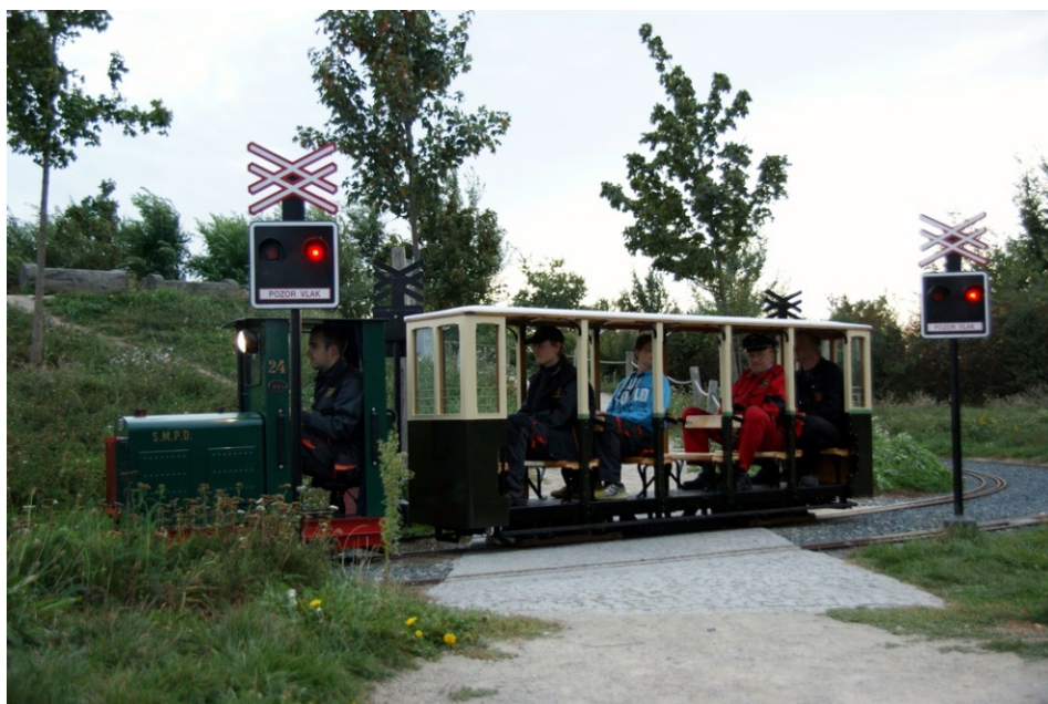
Přejezdové zabezpečovací zařízení v provozu
