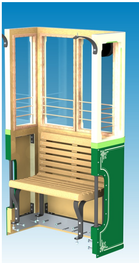
Detail čela vozu s montáží sedadla
