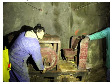
Náročný start jednoválce Jenbacher Werke Jw20 1958 pomocí žhavicího knotu
