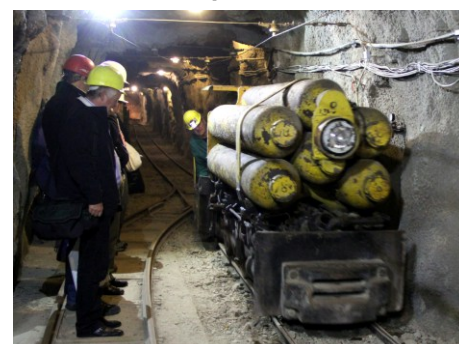
Tlakovzdušná lokomotiva BVD35 z Vítkovic, lahve jsou pro tlak 180 barů
